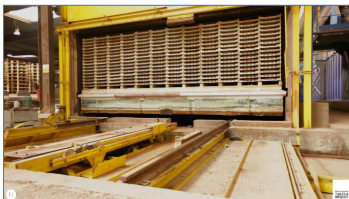
Figure 4 : Section d'un four de tuiles de terre cuite, vue de l'empilage des réfractaires supportant les tuiles
